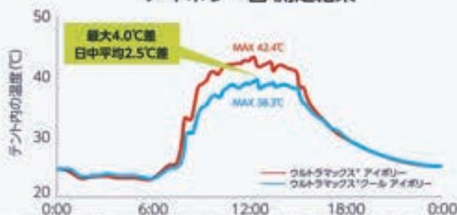
1間×1.5間の扇形テントに各膜材をつけ、内部温度の経時変化を測定(測定月8月)
