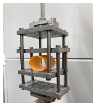
※ 1 ループ試験の様子
